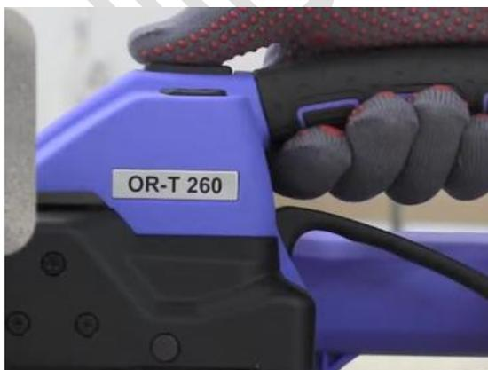
**半自动模式**：一直按住拉紧按钮，直到达到所设定的拉紧力。然后带被自动焊接，上带被切断。也可随时按下焊接按钮手动进行焊接。
