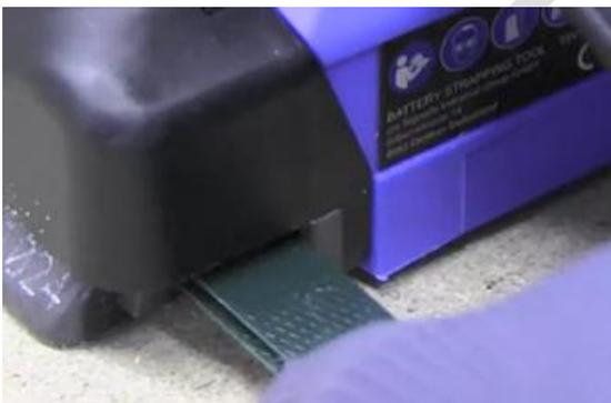
左手将上端打包带插入机器后端的束紧轮和熔接齿板之间的熔接夹持器中，直到固定打包带后停止。
